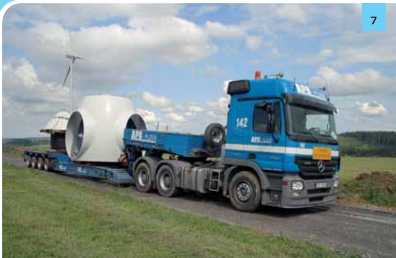
Přeprava náboje rotorové části VTE
