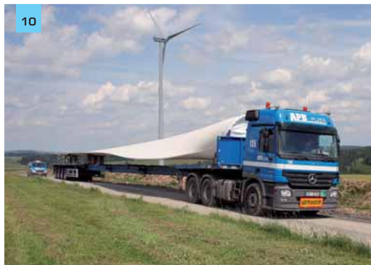
Přeprava listu rotoru VTE
