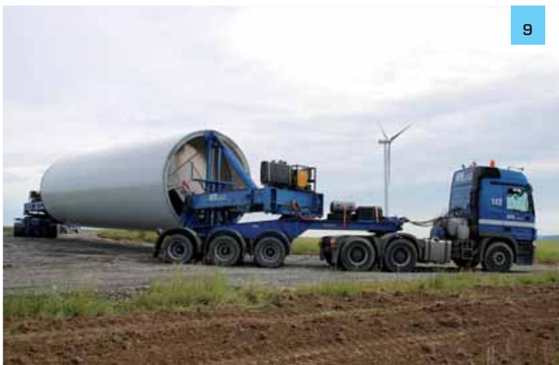
Přeprava jednoho ze segmentů věže VTE
